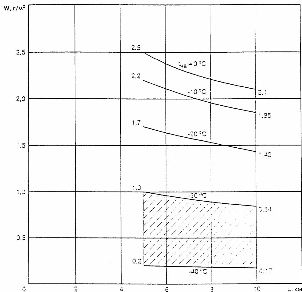
Рис. 4. Зависимость водности от горизонтальной протяженности зоны обледенения в условиях максимального кратковременного обледенения в диапазоне высот от 1200 до 11000 м для облаков (кучевообразных) со среднеарифметическим диаметром капель 20 мкм. При  $t_{HB} = -30\dots-40^{\circ}\text{C}$  – зона возможного расширения условий (по требованию Заказчика)
