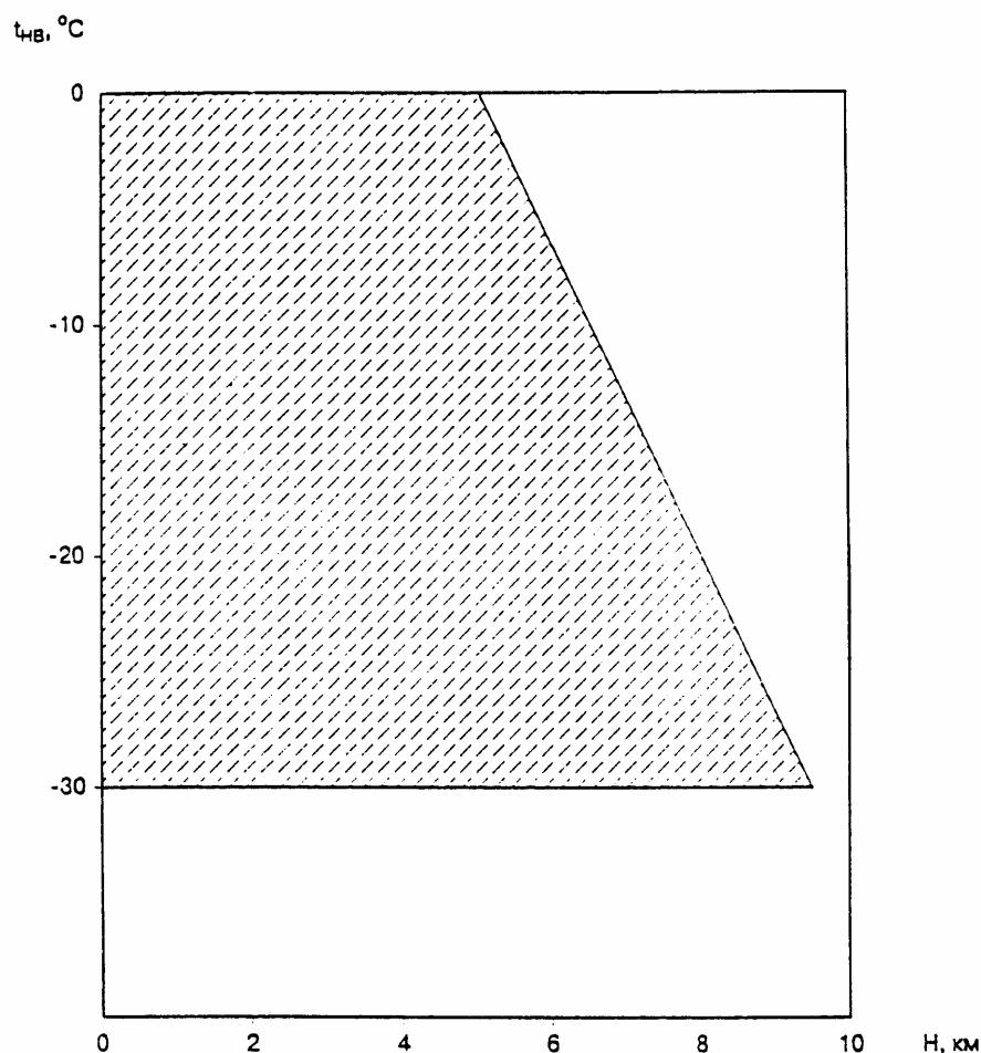
Рис. 3. Зона возможного обледенения, определяемая высотой и температурой наружного воздуха, для условий максимального длительного обледенения
