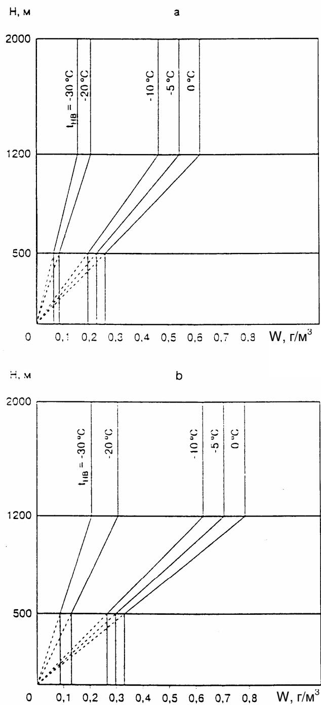
Рис. 2. Зависимость водности от вертикальной протяженности зоны обледенения:
