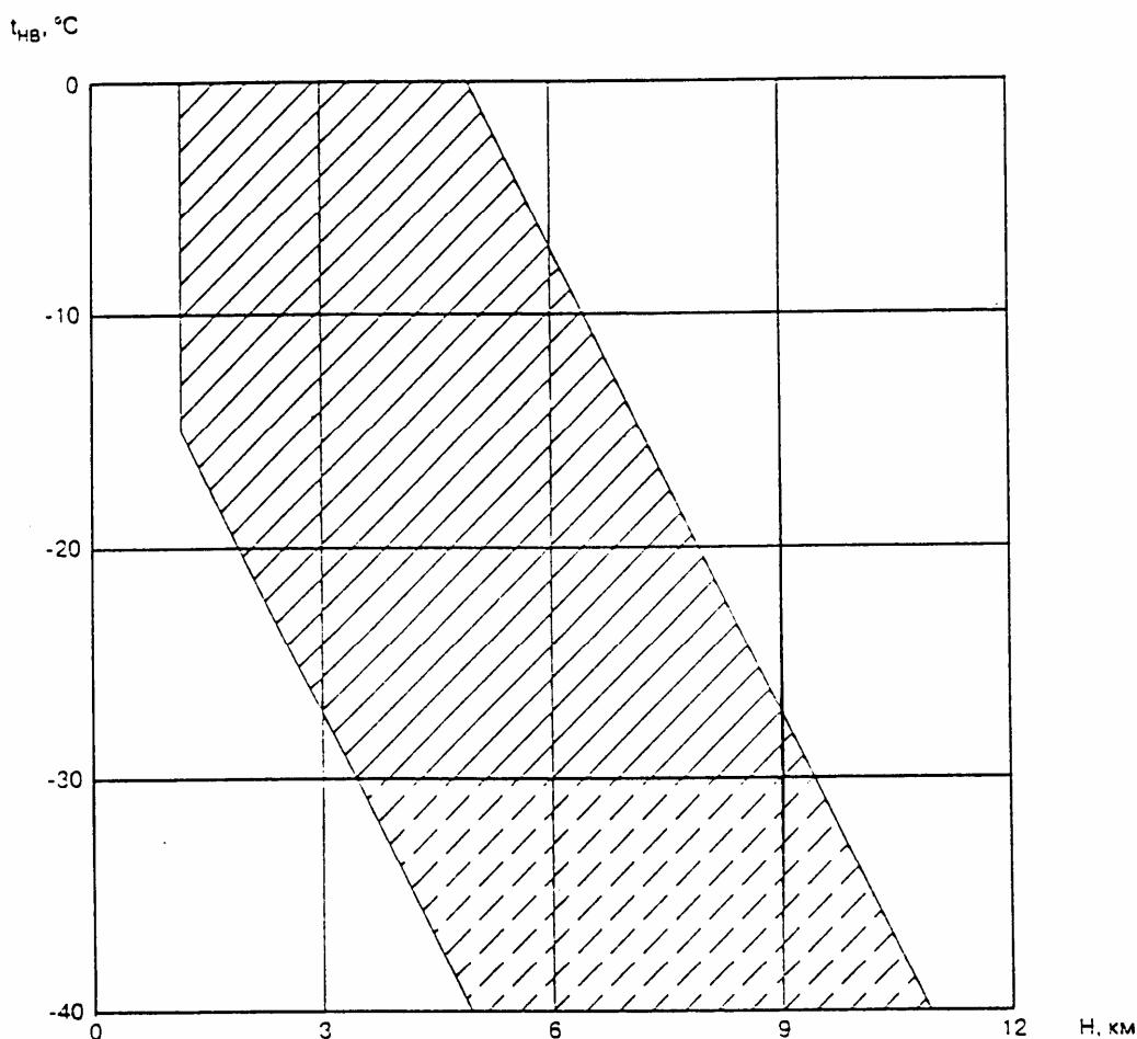
Рис. 5. Зона возможного обледенения, определяемая высотой и температурой наружного воздуха, для условий максимального кратковременного обледенения.
